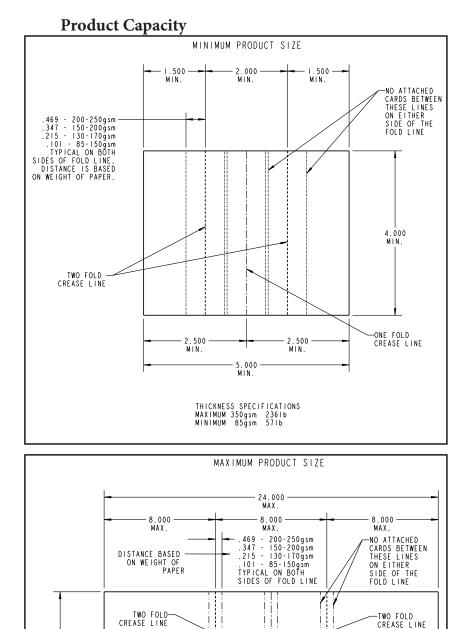
THICKNESS SPECIFICATIONS MAXIMUM 350gsm 2361b MINIMUM 85gsm 571b
